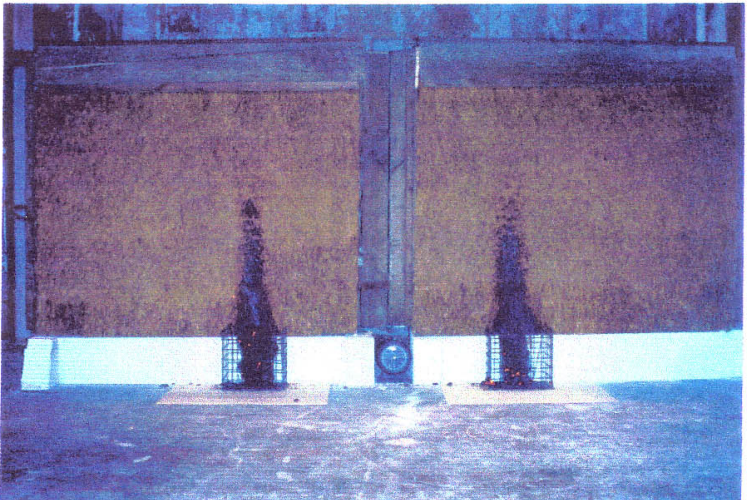
Foto 3: De houtwol is vrijwel opgebrand; het riet brandt of smeult niet meer.
