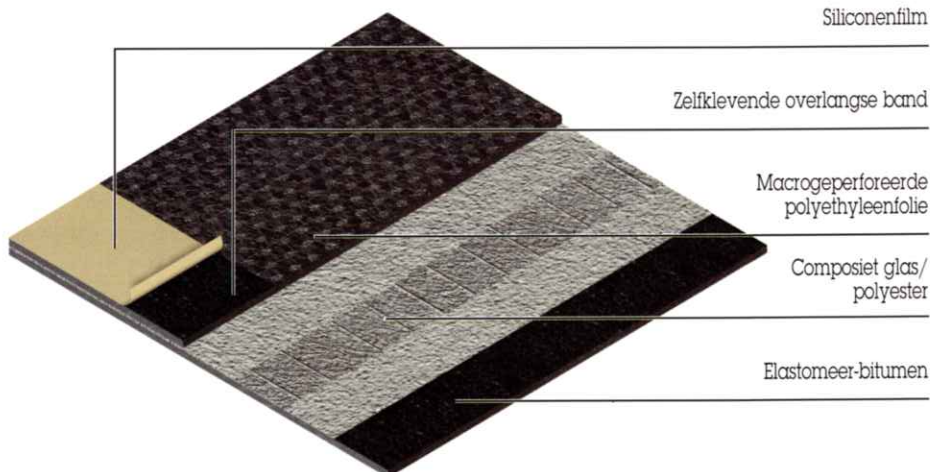
Membraandoorsnede
