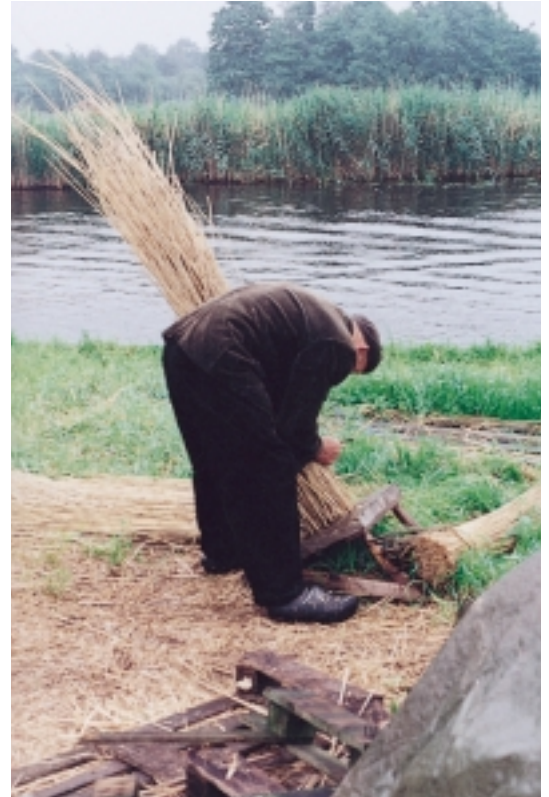
Nadat de rietstengels zijn vlak gestoten, wordt de bos gebonden
