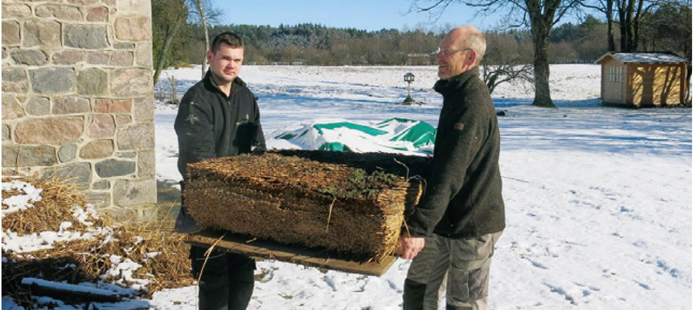
foto: Rietdekker Ruud Conijn en zijn medewerker nemen een testmonster uit een 32 jaar oud rieten dak.
